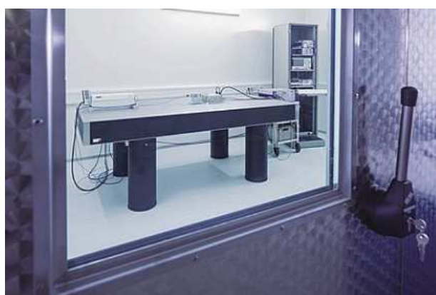
Fig. 1 查看具有六重隔离的纳米计量实验室。在受控的环境条件下全自动执行测量。
