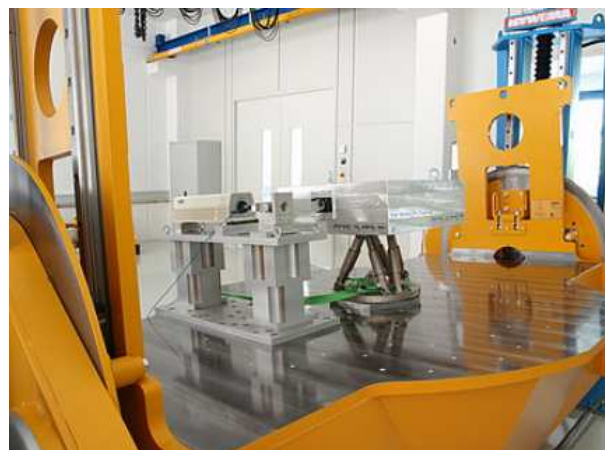
Fig. 5 在卡尔斯鲁厄的 PI，提供了专门用于根据应用测量或检验产品的提升和倾斜设备。在该图中，示出了正在干涉测量带负载的六足位移台
