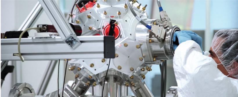
PI提供高精度解决方案，可在达 $10^{-10}$ 百帕的真空条件下进行定位。真空中的定位解决方案应遵循明确定义的约束条件。这适用于安装空间受限以及防止污染和过多热量输入的情况。
