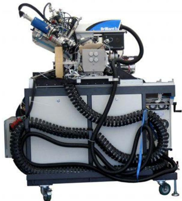
Abb. 4 Neues Beamline PLD-System für In-Situ Synchrotron-Beugung (Bild: SURFACE)
